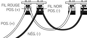
**Schéma 2. Raccordement en série**
